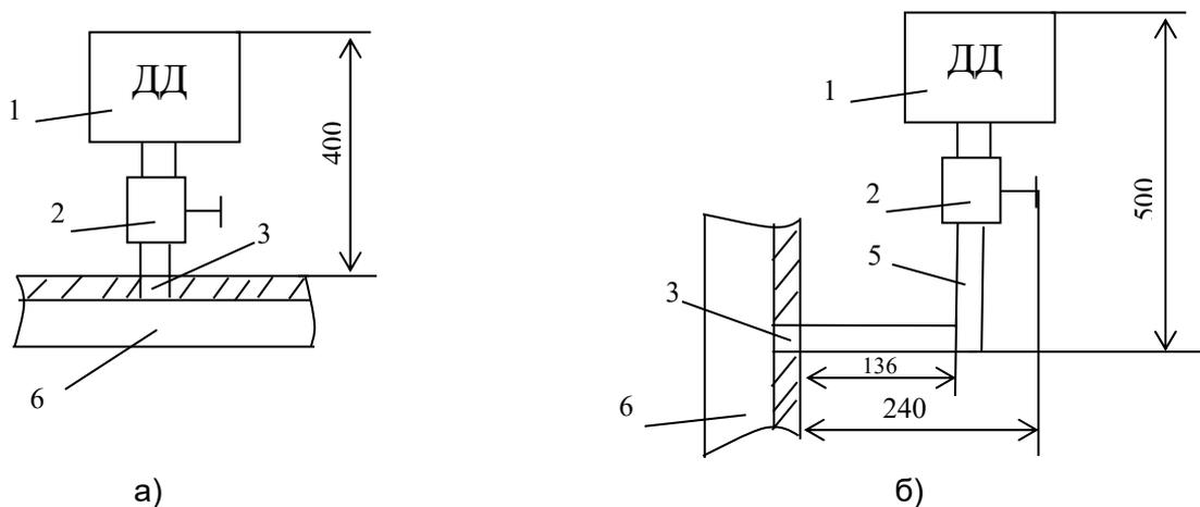
Рисунок 4 – Установка датчика давления на трубопроводе до  $P_y = 1,6$  МПа и при температуре до 80 °С (измеряемая среда – газ, жидкость) горизонтально а) и вертикально б)
